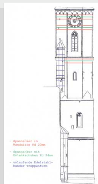
Abb. 3: Übersicht Spannankerebenen und statische Sicherung des Treppenturmes
